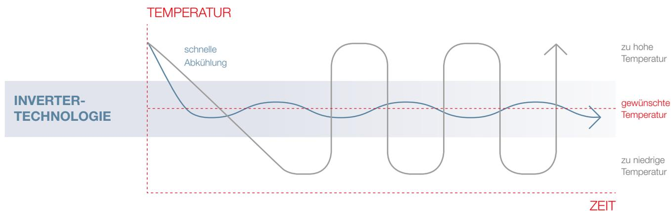
Die TOSHIBA Invertersteuerung nutzt für den Kompressor zwei verschiedene Antriebsarten: Entweder wird die **Pulsweitenmodulation** (hohe Effizienz / PWM) für einen sehr effizienten Betrieb im Teillastbereich oder die **Pulshöhenmodulation** (hohe Leistung / PAM) für ein schnelles Erreichen der eingestellten Solltemperatur angewendet.
